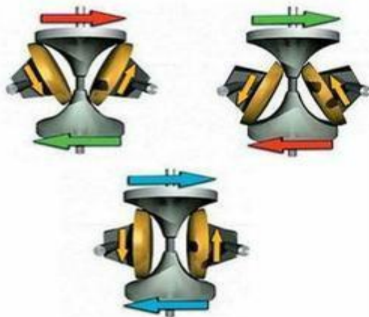
7 pav. Toroidinio CVT veikimas [3]
