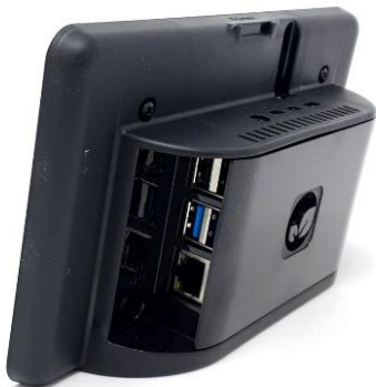
4 pav. Mikrokompiuteris Raspberry Pi korpuse su liečiamu 7“ ekranu [9]
