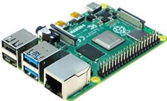
3 pav. Raspberry Pi mikrokompiuterio vaizdas be korpuso [8]
